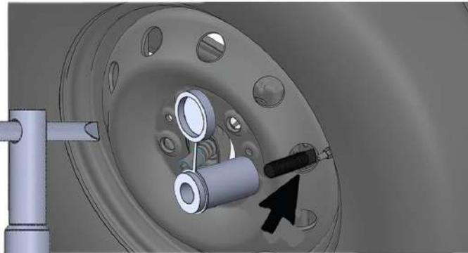
Coloque o guarda pó (D) após o uso
