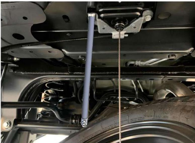
2º Passo: retire o parafuso esquerdo do redutor e parafuse o reforço central (C) com com o mesmo parafuso original do redutor.
