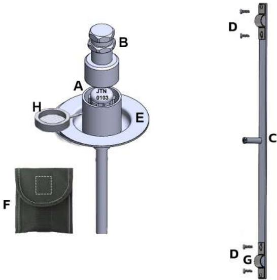
2° Colocar o pneu no lugar e inserir o antifurto (A) que está junto com a calota de sustentação (E) no cubo da roda, conforme figura abaixo. Aperte com a chave segredo (B) o corpo principal.
