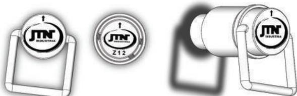
3º passo: Insira o corpo principal, juntamente com a chave segredo, no parafuso da porca original retirada;
