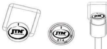
6º passo: insira o corpo principal, juntamente com a chave segredo, através do furo da calota de sustentação (C).
