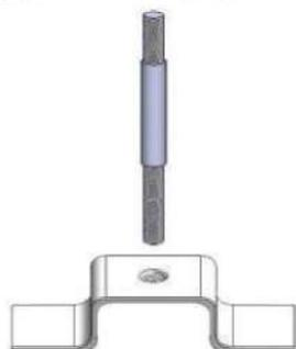
5º passo: Coloque a calota de sustentação (C) no centro do estepe; OBS: Para utilização no VERSA com Estepe SLIM e CRETA 2024 inverter a calota de sustentação conforme figura 2.2
