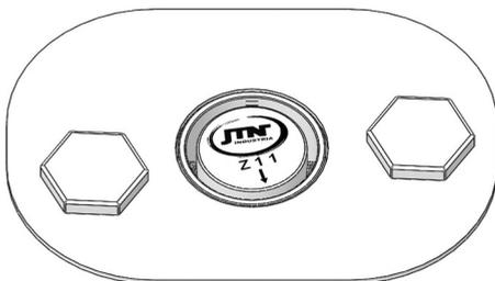
3º passo: Encaixe o suporte de fixação no gancho do sistema antifurto e siga as instruções a seguir para concluir a instalação;
