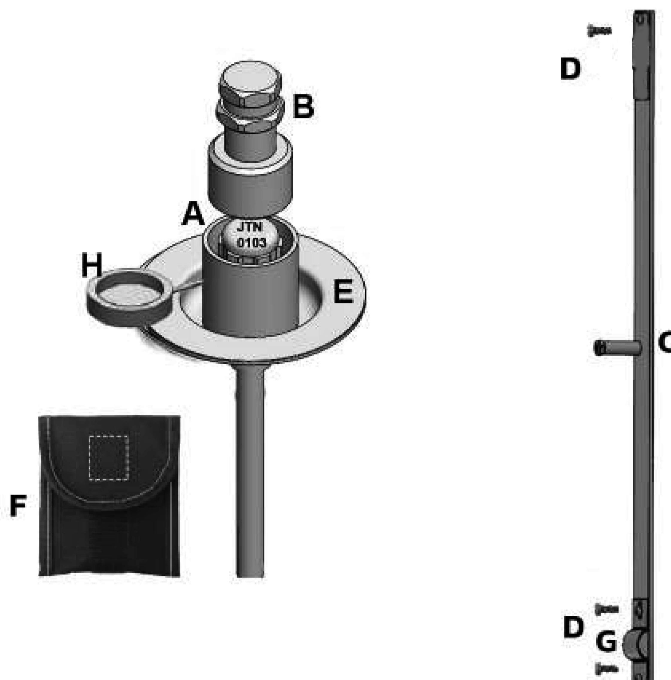
2º Colocar o pneu no lugar e inserir o antifurto (A) que está junto com a calota de sustentação (E) no cubo da roda, conforme figura abaixo. Aperte com a chave segredo (B) o corpo principal.
