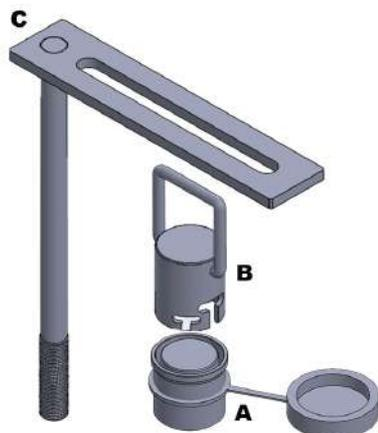
3° Suba o estepe centralizando o parafuso do suporte (C) dentro de um dos furos da roda conforme figura abaixo.
