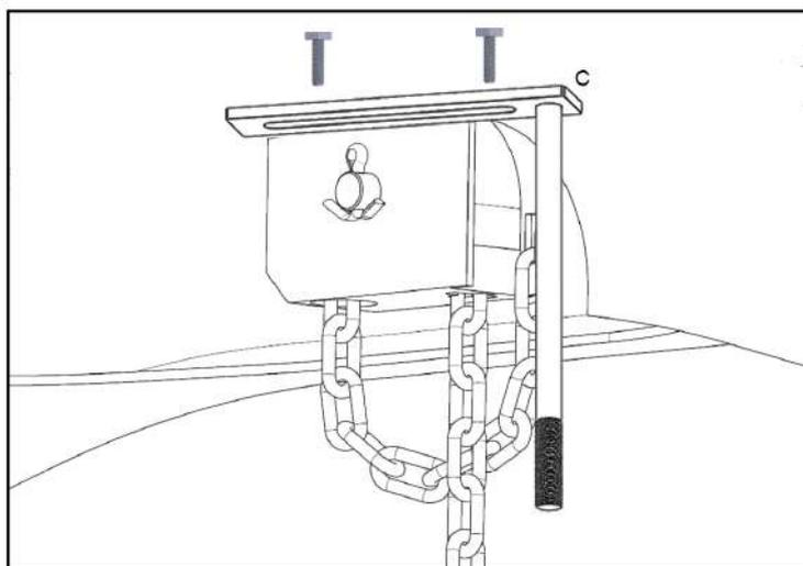
2° passo: Retire o redutor desparafusando os dois parafusos de fixação coloque o reforço central (C) como mostra na figura acima. Fixar o redutor sobre o redutor do item (C), através dos parafusos originais do redutor.
