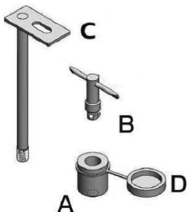
3º Suba o estepe centralizando o parafuso do suporte (C) dentro de um dos furos da roda conforme figura abaixo.
