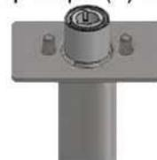
4º passo: Por baixo da caçamba, sequencialmente acople ao corpo principal (B), o anel retentor (G), encaixe o sistema ao redutor do veículo pressionando, pelo lado de fora o sistema. Mantendo a pressão, ajuste os parafusos do anel retentor (G) assinalados;
