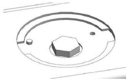
7º passo: Encaixe o tampão (C), no lugar da tampa original do acesso ao sistema de fixação do estepe e alinhe o furo do mesmo com o furo de onde foi retirado o parafuso no passo anterior;
