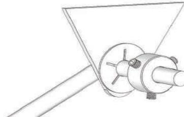
4º passo: Recoloque o estepe na bandeja, inserindo a calota de sustentação (F) no centro da roda e fixando-a com o corpo principal (A). Use a chave (B) para rosquear o corpo principal no pneu;
