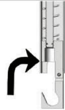
6º passo: Girando a chave segredo, rosqueie o sistema até que o canal existente na ponta do corpo principal passe pela base do elevador;
