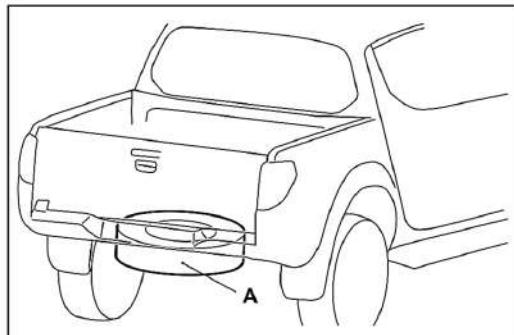
4º passo: coloque novamente o estepe no lugar e acople a chave segredo no orifício original ascionando o antifurto e recolhendo o estepe conforme figura abaixo
