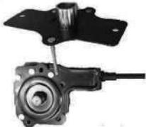
5º passo: Encaixar o corpo principal (A) na bucha trava (C) e travar com os parafusos allen M3 conforme foto, e recolocar o suporte do redutor conforme foto
