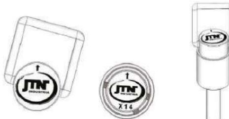
4º passo: Insira o corpo principal (A) juntamente com a chave segredo (B), através do furo da calota de sustentação conforme passo 2º.
