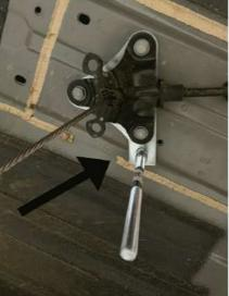
3º Suba o estepe centralizando o prisioneiro do suporte (C) dentro de um dos furos da roda conforme figura abaixo.
