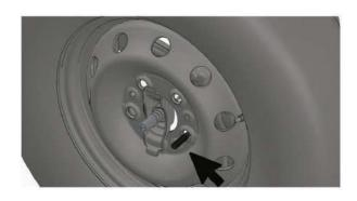
4º Rosquei o antifurto de estepe (A) no parafuso (C) conforme figura abaixo, com a chave segredo (B), alinhando as setas. após rosquear até o final, tampe com o guarda pó (D) para evitar que entre sujeira no sistema
