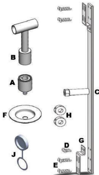
3º passo: Insira os anéis de travamento (H) nas hastes direita e esquerda da articulação traseira da bandeja do veículo e aperte os parafusos para que o componente se trave;
