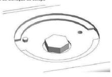
7ºpasso: Encaixe o tampão (C), no lugar da tampa original do acesso ao sistema de fixação do estepe e alinhe o furo do mesmo com o furo de onde foi retirado o parafuso no passo anterior;
